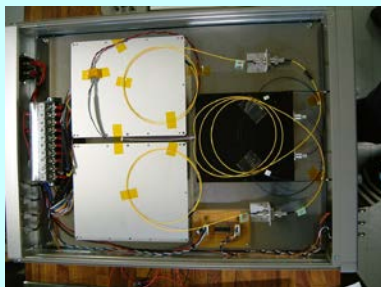
超短パルス増幅用30dBm EDFA
