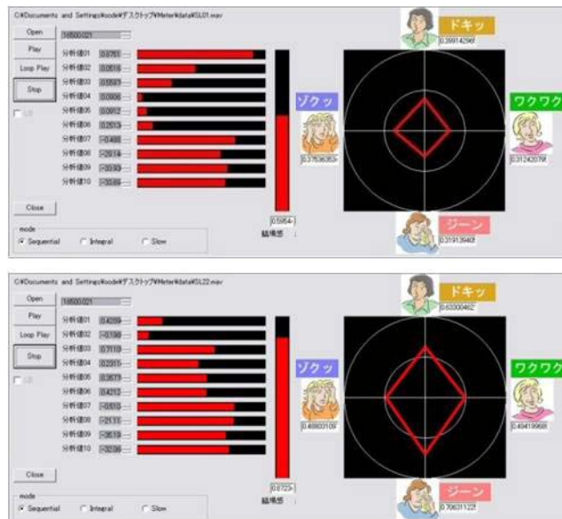
試作した超臨場感メータ：SLの通過音の分析例 (上) 1チャンネル再生 (下) 22チャンネル再生
