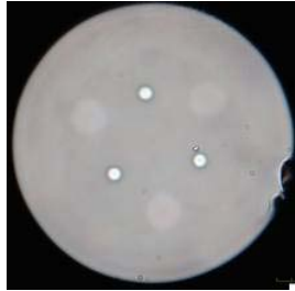
試作した3コア型MC-EDF
