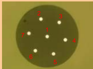
マルチコアファイバ(コア間隔50um)の端面
