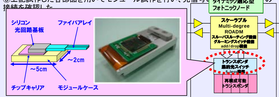
8x8超小型シリコン光スイッチモジュール
