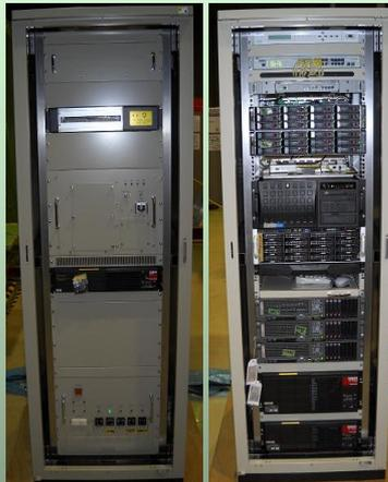
レーダ制御装置 レーダ処理装置
