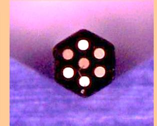
V溝に面接触している光ファイバ
