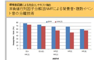
時間方向の特徴も考慮し、従来のMFCCベース方式と比較して10%程度の精度向上を達成
