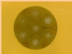
フェルール孔構造の変更による加工作業性の向上
