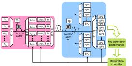
運用中の鍵生成特性を定期的に 取得してフィードバック制御を行う ことにより、長時間運転中に変動 しやすいパラメータを能動的に最 適化するソフトウェアを開発した。
