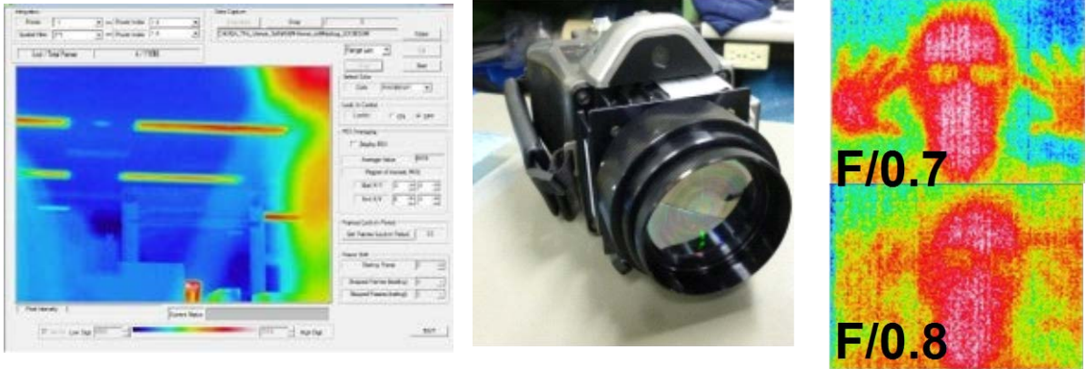
図3 VGA-THzカメラの開発と、高集光レンズの開発
