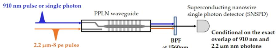
量子ドットから発生される波長910nm単一光子をPPLN導波路ダウンコンバーターで波長1,560nmに変換する。
