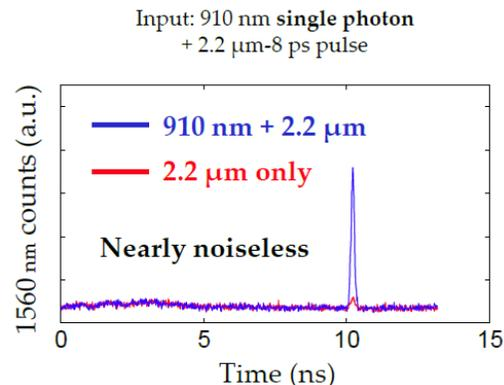
•雑音光子を発生することなく、波長910nmの単一光子を波長1.560 μmへ変換することに成功した。
