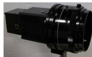
開発したVGA-THzカメラとアクティブイメージング用レンズ
