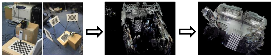
全方位カラーカメラによるデプスカメラの画素数向上処理の例
