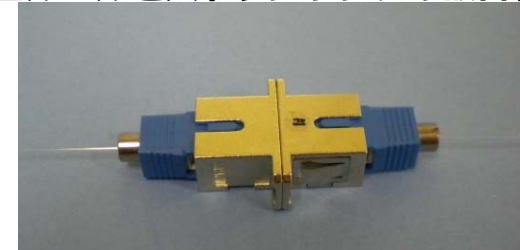
MCFコネクタによる接続状態
