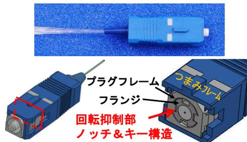
SCコネクタ型FIFOの外観と内部構造
