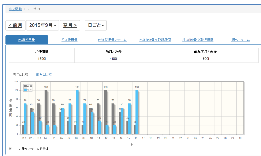
図4. 水道およびガス使用量の見える化画面
