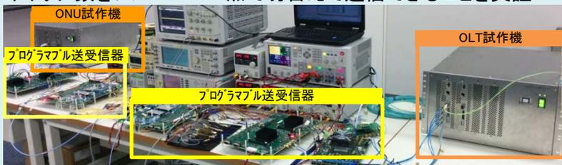
＜プログラマブル光送受信器を用いたOLT-ONU間通信実験の様子＞
