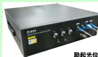
励起光位相制御光回路ユニットの外観
