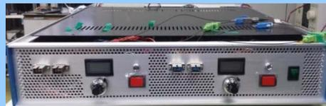
19インチ2UI筐体に2台の増幅器を収納した試作器の外観
