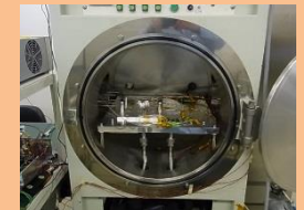
遅延干渉計(DLI) 真空評価
