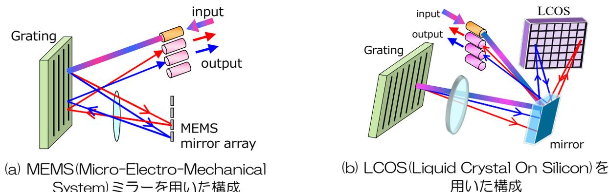
図 1-2 波長選択スイッチの代表的な構成
