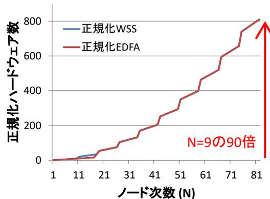
図 1-4 N × N ノードにおける必要ハードウェア数の変化 (N=1 の値で正規化)
