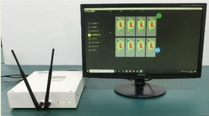
・運動企図検出装置を構成する基本演算モジュールと脳活動表示器
