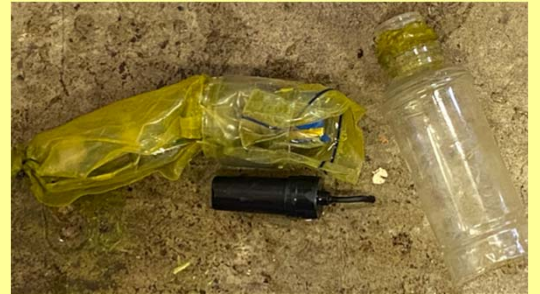
図3 破損したpHセンサ
