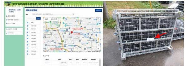
図4. 鉄コンテナの位置情報(左)および取り付けたGPSユニット(右)
