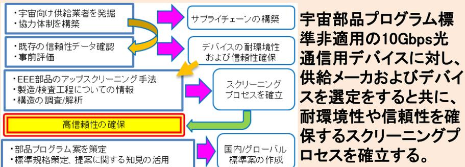
宇宙部品プログラム標準非適用の10Gbps光通信デバイスに対し、供給メーカーおよびデバイスを選定をすると共に、耐環境性や信頼性を確保するスクリーニングプロセスを確立する。
