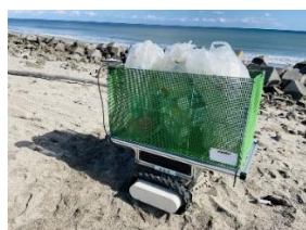
図 2 開発した高精度衛星測位 CLAS による海ごみ自動運搬ロボットと自動走行実験の軌跡
