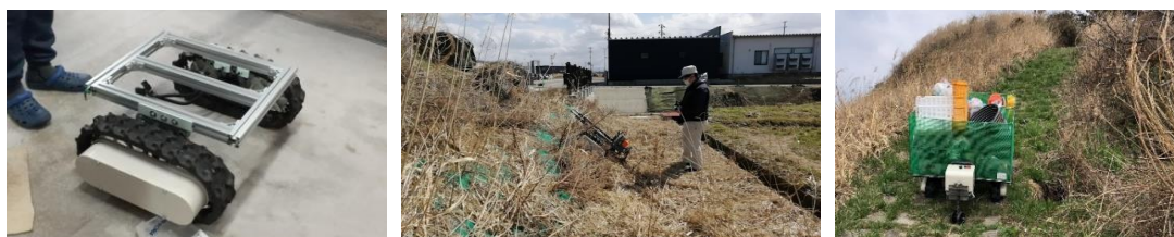
図 4 開発した砂礫海岸線および斜面を走行可能な海ごみ自動運搬ロボットと運搬走行実験
