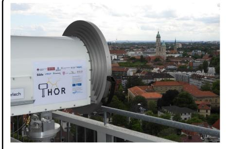
世界初の300GHz双方向無線伝送システムの実証 ドイツ・ブラウンシュバイクでの屋外実証実験の様子 伝送距離160m、伝送速度20Gb/sx2(双方向)
