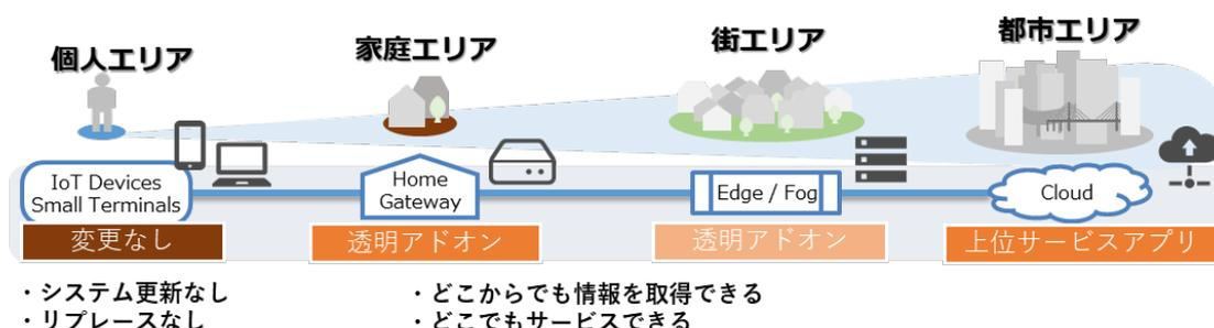
図 1 透明アドオンによるネットワーク途中での情報取得・サービス提供のイメージ
