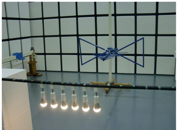
図2.2-5 LED照明からの漏洩磁界測定
