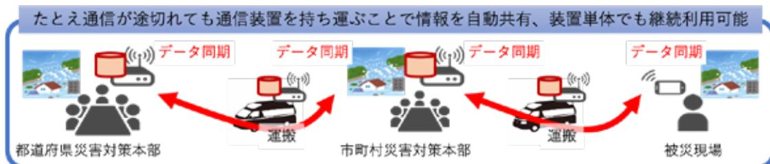
インターネットにつながらない環境下でも普段利用しているアプリケーションサービスをそれぞれの拠点で使うことを想定し、複数のローカルサーバ間で安全に情報同期させるため、Wi-Fi接続を高速かつ安全に行う分散型認証システムに加え、Wi-Fiとは別の通信手段を用いて鍵情報を伝送する仕組みも組み込んだ、独自の技術が入っています。
