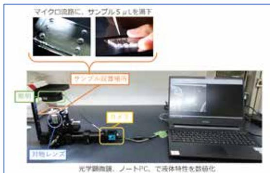
計測システム(マイクロ流路、顕微鏡、PC)
