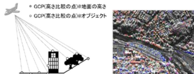
参照点(GCP)候補を自動的に分類し、適したGCPのみを用いることで干渉SAR観測の計測パラメータの推定精度を向上させます。
