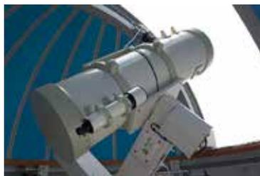
図1 鹿島宇宙技術センターの反射望遠鏡 口径35cm、焦点距離1248mm
