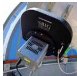
図2 主焦点に取り付けたCCDカメラ（1600万画素、撮像素子サイズ36 $\times$ 24mm）とフィルターホイール
