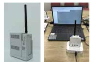
無線端末: (左) センサ搭載型、(右) 低遅延対応汎用型
