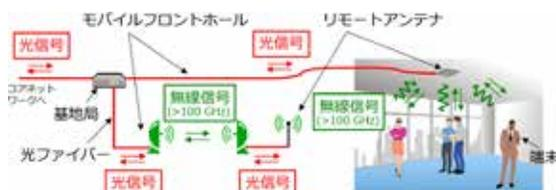
図1 Beyond 5Gで想定される信号変換の模式図
