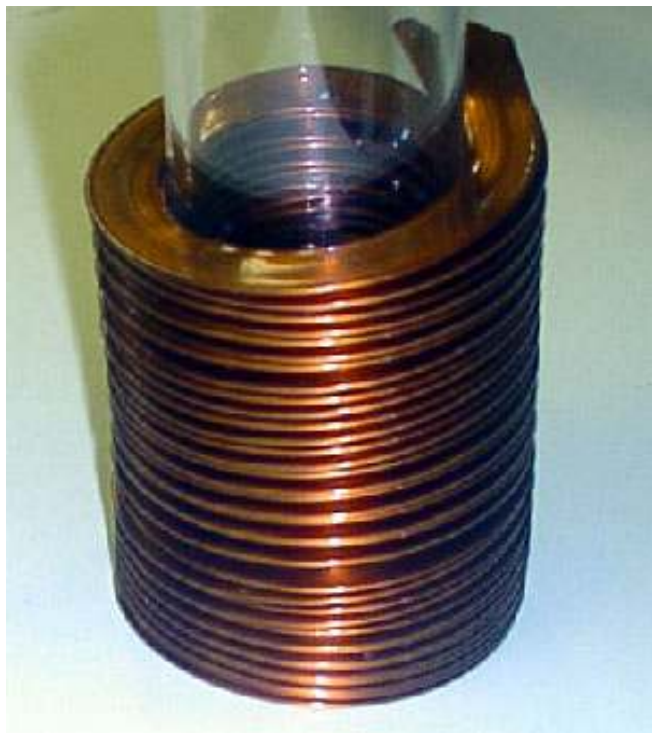
図 5.3.1.3 二重螺旋構造を用いた駆動力発生機構
