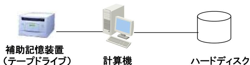
図 39 一般的なノンリニア映像編集システムの構成
