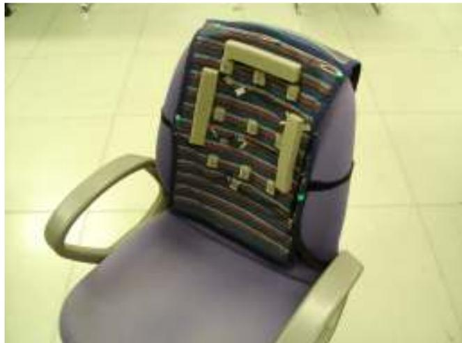
図 5.3.2.3 分布型振動触覚提示装置
