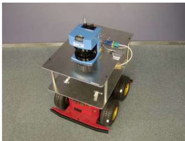
図9 レーザー距離センサ搭載移動ロボットの外観
