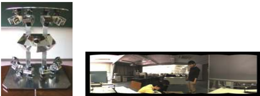
図5 12台カメラ構成によるミラー式マルチカメラシステムと撮影映像
