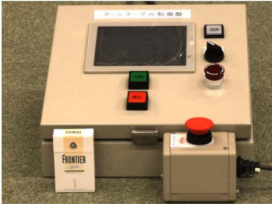
図 1 7 - 3 机上操作盤（中央）および非常停止ボタン（右下）
