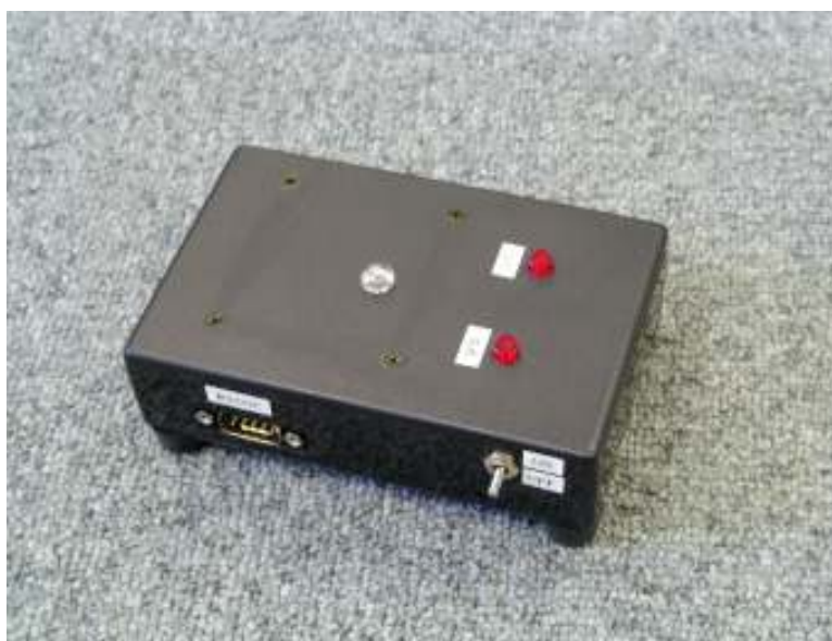
図 2 5 : 無線化振動刺激システム送信ユニット（親機）
