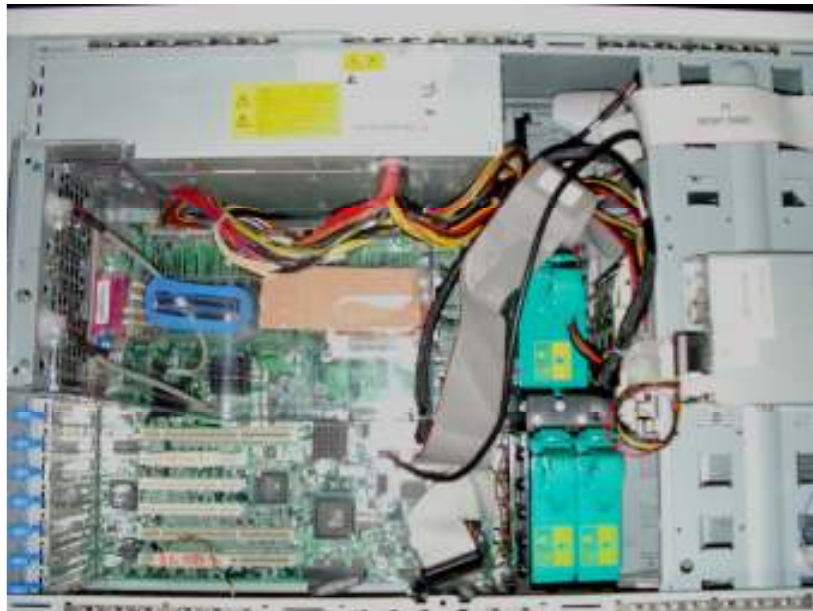
図 5-1-3-3-1-1 試作サーバーの筐体内部 (写真)
