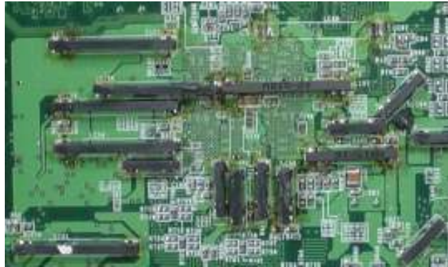
図 5-1-3-2-1-7 LILC を適用した North Bridge 回路周辺（写真）
