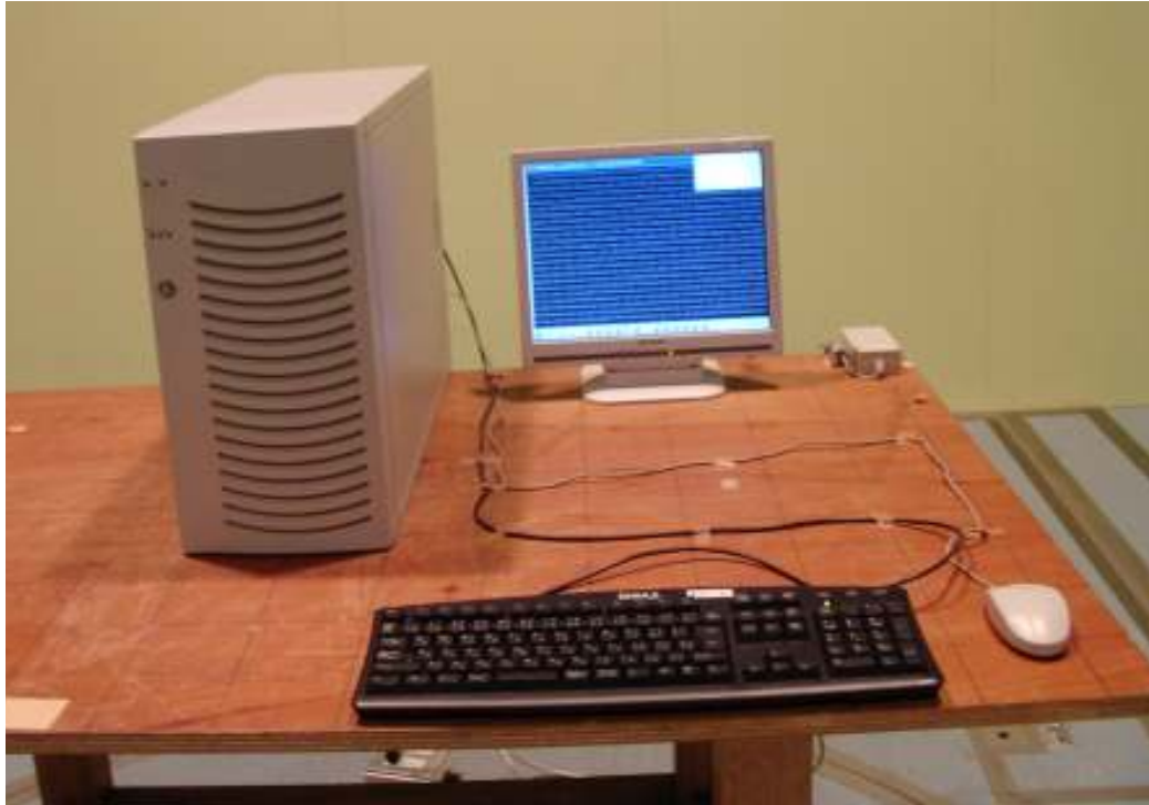
図 5-1-3-3-2-1 試作サーバの EMI 測定風景（写真）
