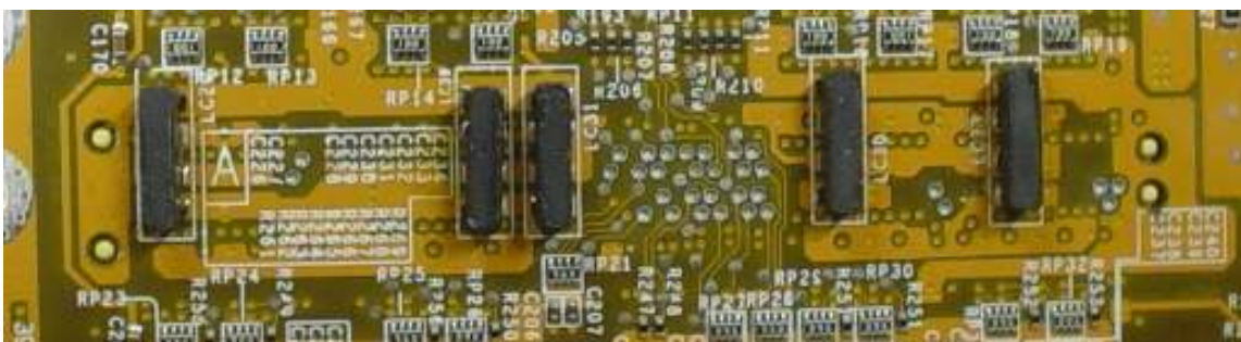
図 5-1-4-2-8 LILC を適用した Memory DIMM 周辺の写真
