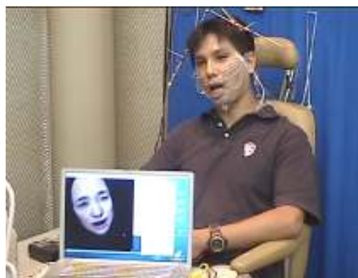
OPTOTRAK センサを装着した話者とリアルタイムトーキングヘッドシステム。左下のコンピュータ画面に別人物の顔画像が生成され、話者の発話タイミングで駆動されている。
