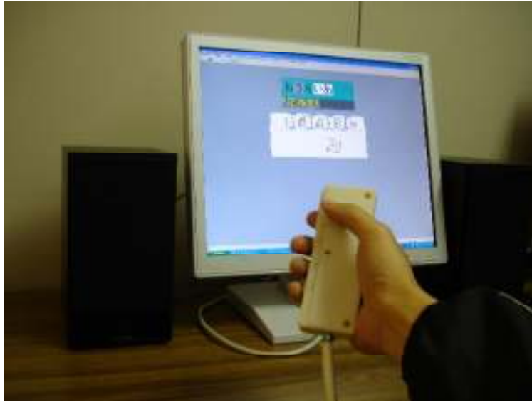
【図4】試作した片手文字入力システムのプロトタイプの概観。5本の指のキーの移動方向を、親指キーは母音発声時の顎の動きに、他の4本の指のキーは子音発声時の舌と唇動きに合わせて設定している。視覚および音声フィードバックを含む学習支援ソフトのプロトタイプも開発した。
