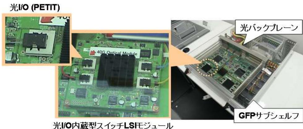
図 4-1-47. 光 I/O 内蔵型スイッチ LSI モジュールの Generation Free Platform (GFP)への適用 (GFP は NEC にて開発)
