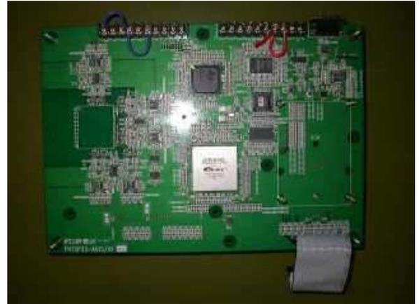
図 4-1-3-2 WSS 制御回路試作品写真
