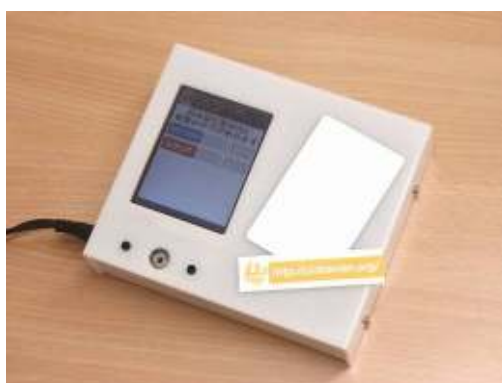
図 1 ソフトウェア無線方式による複数プロトコルに対応したリーダライタ
