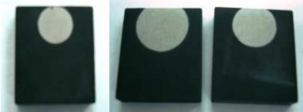
図4-3-6 電波透過窓の位置、大きさの評価に用いた窓付きリッド (タイプAおよびタイプC)
