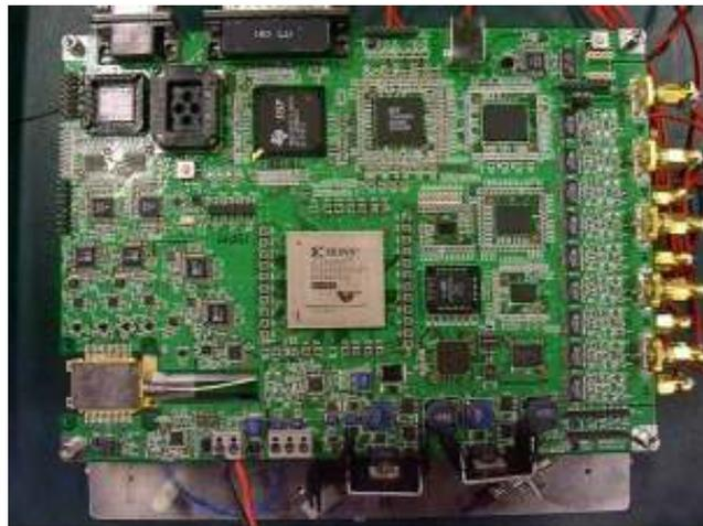
図 4-4-2-2 偏波モード分散補償モジュール写真
