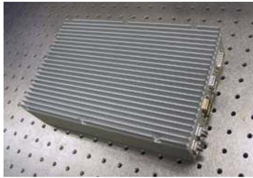
図 4-3-3 波長・偏波分散補償器の外観
