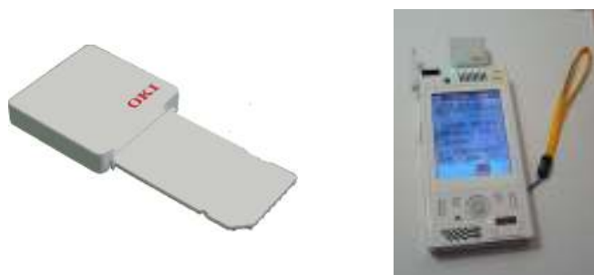
図 4 SDIO カード (左) と同カードを実装したユビキタスコミュニケーター
