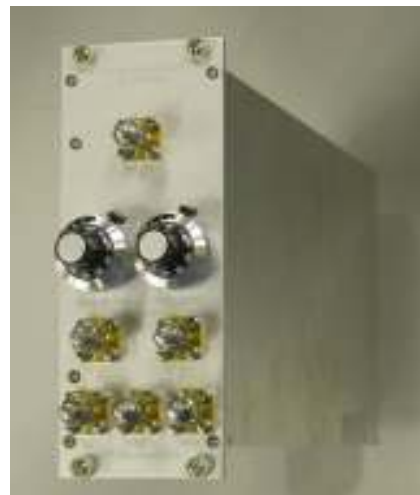
図 4-1-3-2 10G バーストモード CDR (NEL 社製) 構成、特性、外観
