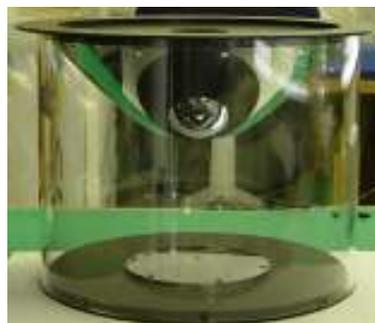
図43 試作2枚反射型全方位ミラー
