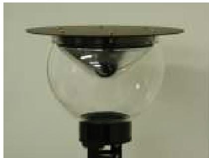
図 39 試作した双曲面全方位ミラー
