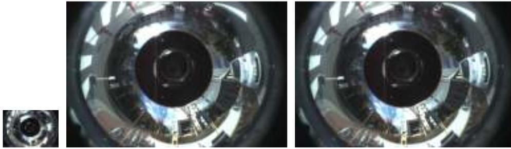
図 31 (左) 低解像度高フレームレート入力画像, (中央) 高解像度低フレームレート入力画像, (右) 高解像度高フレームレート生成画像
