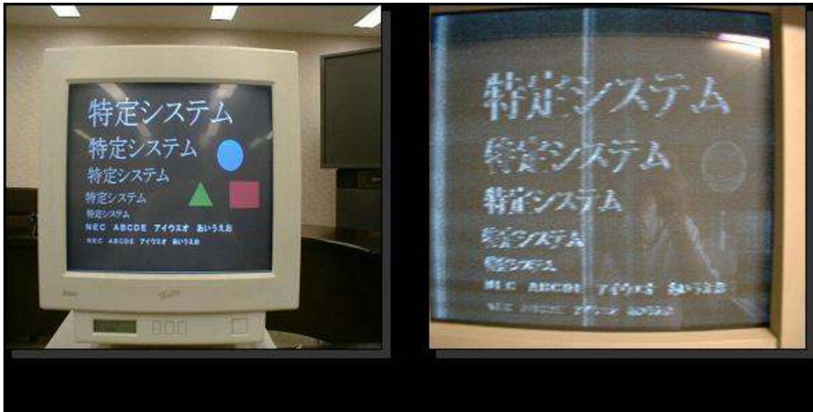
図 1-1. 漏洩電磁波盗用画面再生実験の一例
