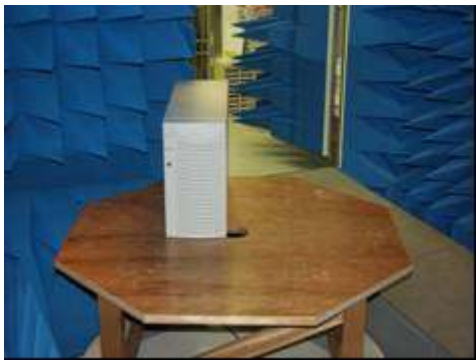
図 4-52 サーバ装置の測定風景
