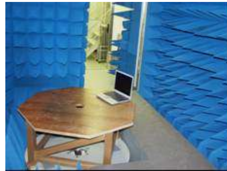
図 4-53 ノート PC の測定風景
