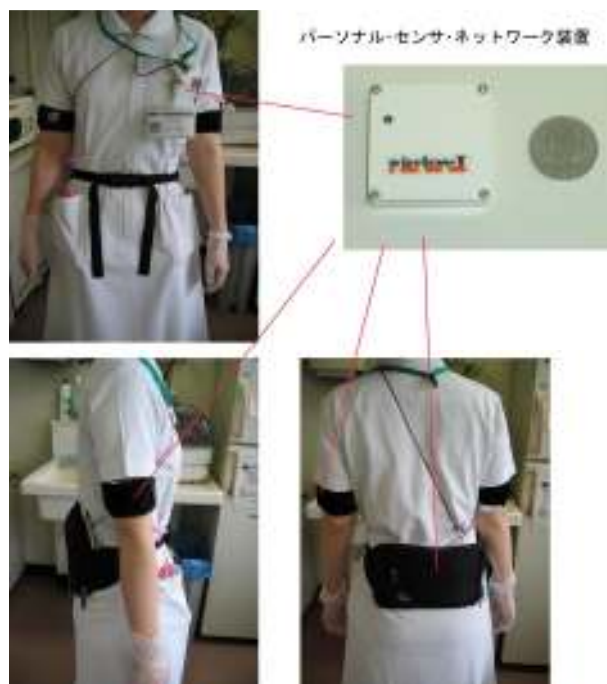
図 4-1-2-4 パーソナル・センサ・ネットワーク装置
