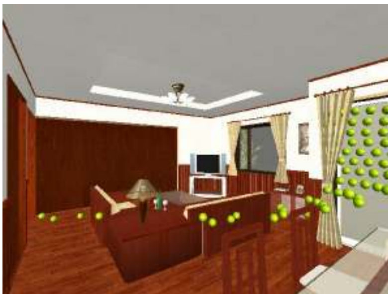
図 4-1-11 建築 CAD 情報と室内気流の流れの合成表示例
